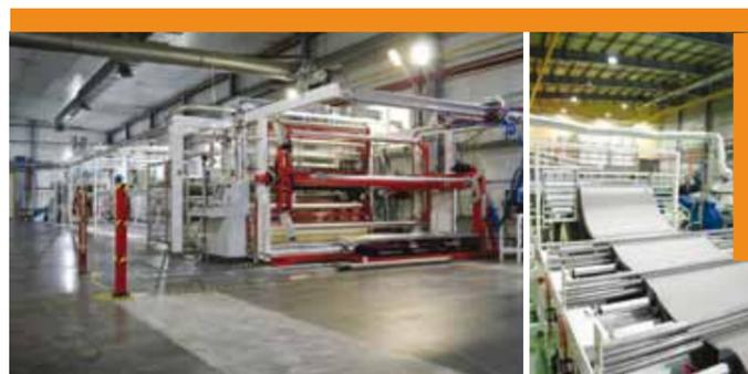
Рис. 2. Новая производственная линия для выпуска вспененного полиэтилена
