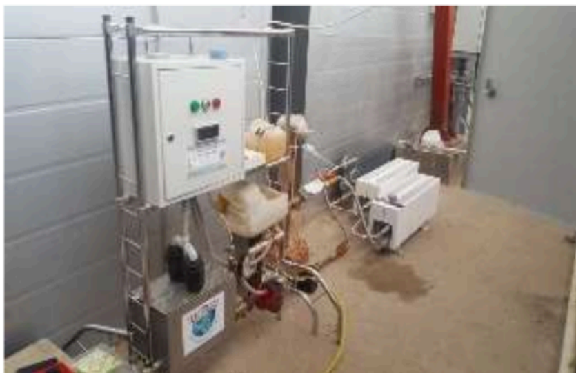
Рис. 4. Фото стенда для проведения испытаний АТП-ТермаРОН
